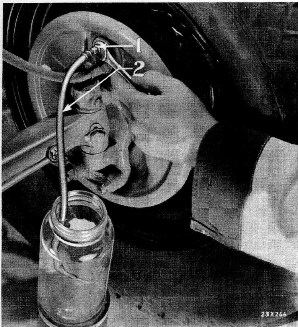
Fig. 37—Bleeding Brake Lines
