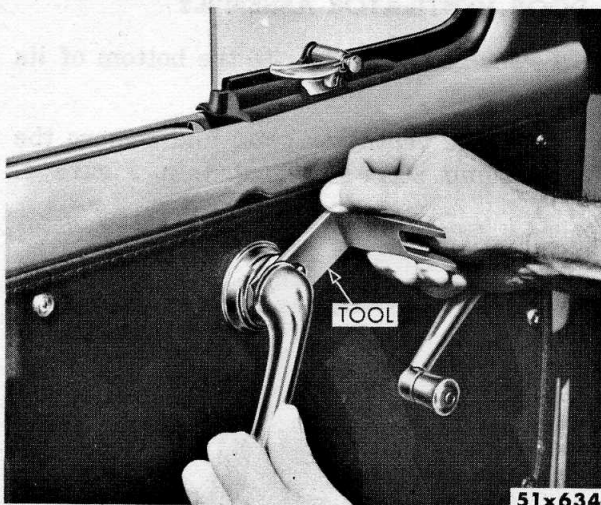
Fig. 1—Removing Inside Door Handle, Using Tool C-533
